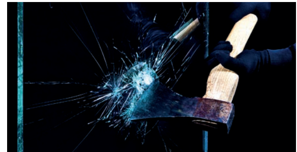
Abb. 7.4: Durchbruchversuch mit Axt
