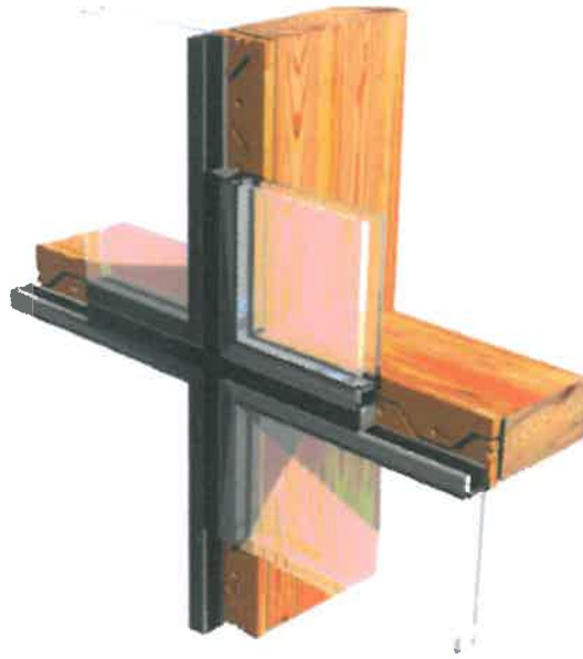
Horizontalschnitt (durch Pfosten)
